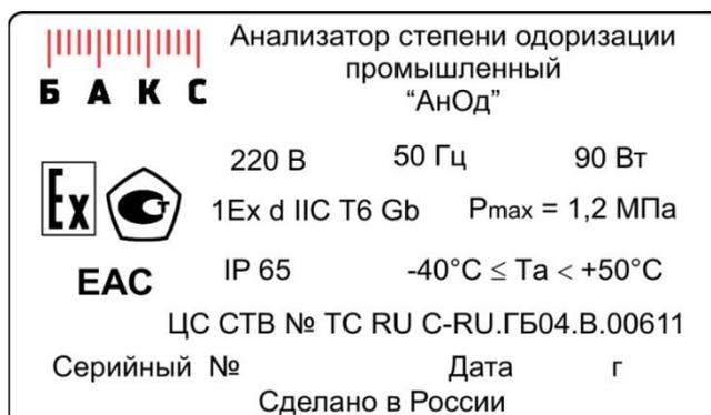
Рис. 6. Табличка, установленная на корпусе анализатора
