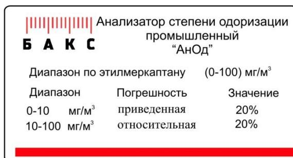
Рис. 7. Табличка с метрологическими характеристиками анализатора
