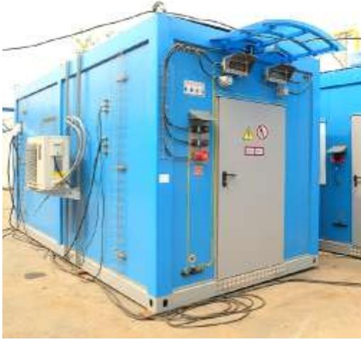
**Блок контроля качества газа (БКК)** предназначен для размещения и установки во взрывоопасной зоне контрольно-измерительных приборов для определения параметров газа (компонентный состав, физико-химические показатели). Габаритные размеры типового БКК: 4,2х2,2х3 м. В зависимости от состава и количества установленного оборудования массогабаритные характеристики БКК по согласованию с заказчиком могут быть изменены.
