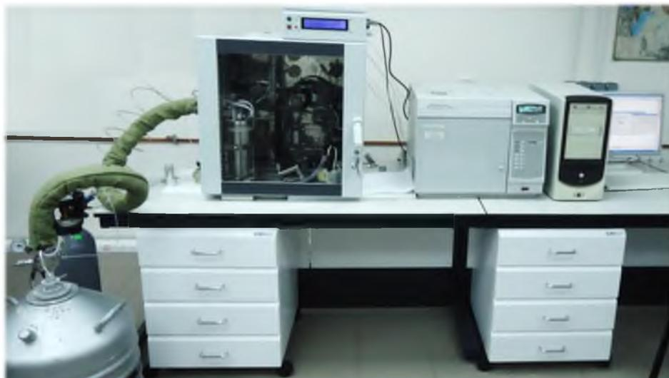
**Стационарная настольная лабораторная измерительная система «Гелий-Микро»**
