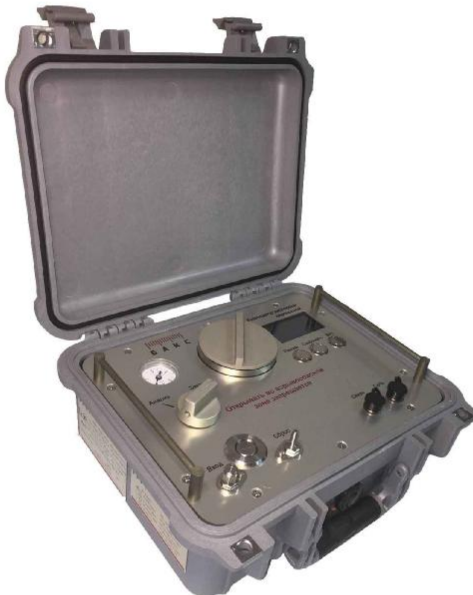
Рисунок 1 – Анализаторы содержания кислорода переносные КС 50.430-000, внешний вид
