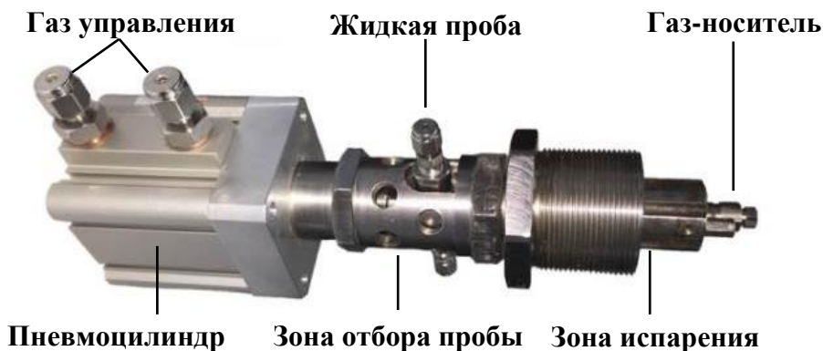
Рисунок 10. Инжектор-испаритель для хроматографа МАГ
