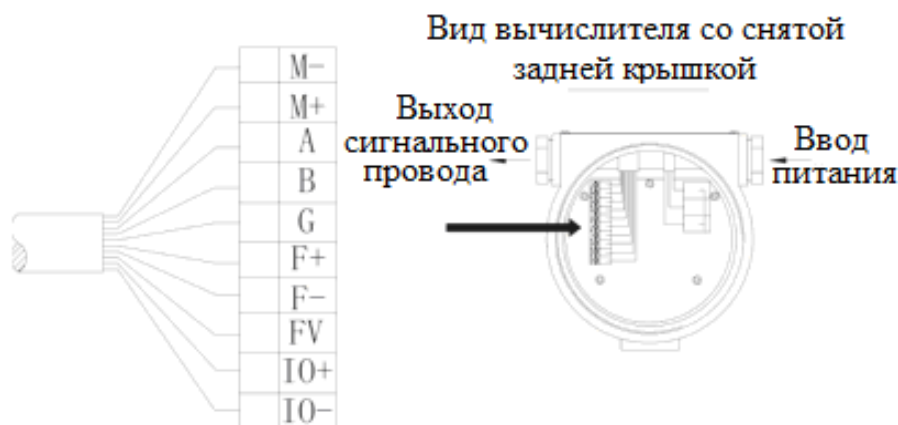
Рисунок 11 Подключение сигнальных выходов вычислителя
