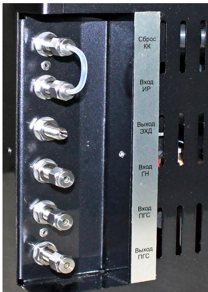
Рис. 7. Газовые вводы(выводы) хроматографа
